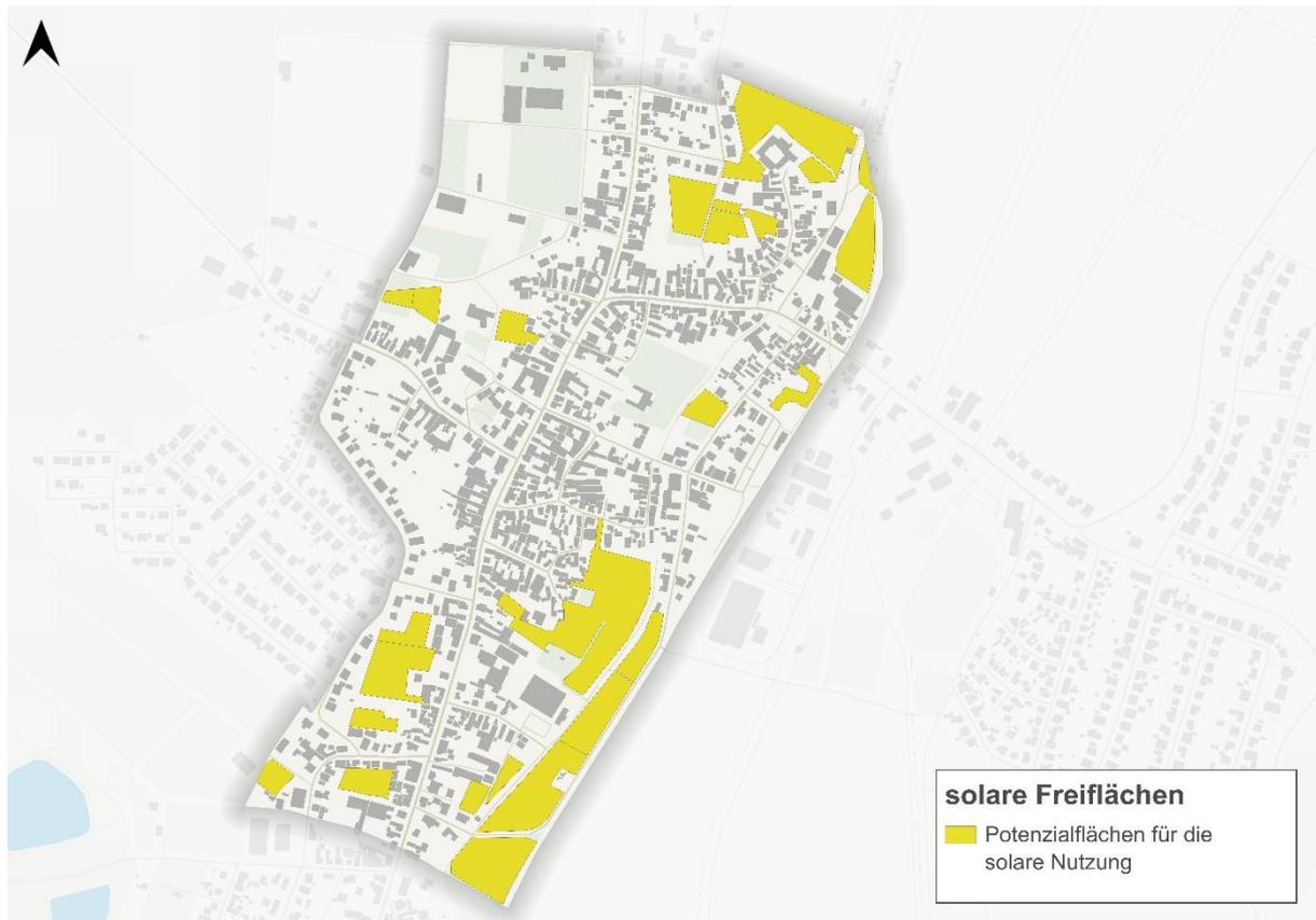
Abbildung 65 Potenzialflächen für die Nutzung von Freiflächen Photovoltaik und Solarthermie
