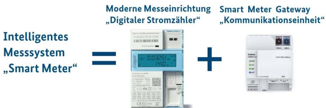
Abbildung 30 Übersicht intelligentes Messsystem<sup>18</sup>
