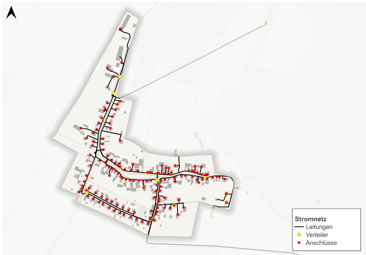
Abbildung 21 Stromnetz inklusive Anschlüssen und Verteilern in Bisses
